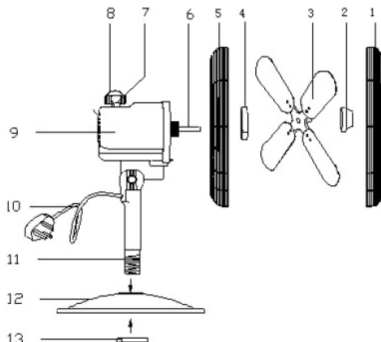
6. Dévissez la vis se trouvant sur l'une des grilles. Placez la grille avant sur la grille arrière, les petits trous ronds situés en bas des grilles doivent correspondre, afin de faire passer la vis. Fixer les grilles à l'aide des 3 clips puis serrez la vis de fermeture.
