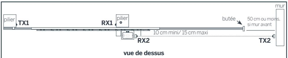
En branchant les photocellules de cette manière, le système réagit à une coupure de l'un ou l'autre des faisceaux infrarouges pendant la fermeture, et du faisceau bord secondaire pendant l'ouverture. Il est important de ne pas oublier le pont entre « - » et « COM ».
