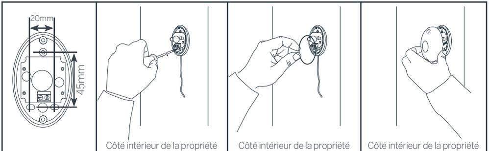
Raccorder électriquement les photocellules et repérer la couleur des fils pour ensuite les raccorder sur la carte électronique.
