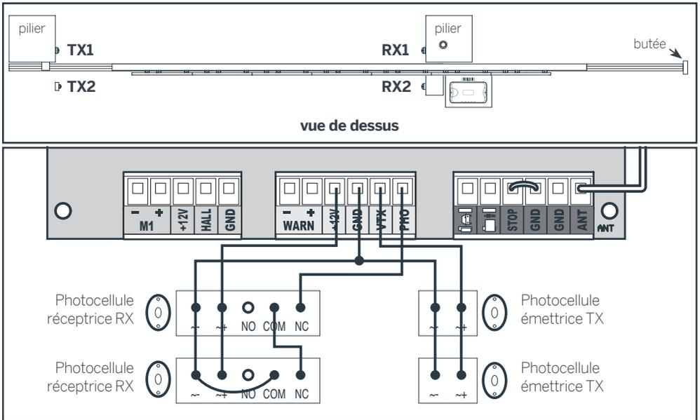
Protection bords primaires et secondaires : dans le cas précédent, le deuxième jeu ne peut pas être monté pour protéger le bord secondaire du portail pendant l'ouverture. Pour ce type de fonctionnement, brancher le deuxième jeu de photocellules sur l'entrée « arrêt d'urgence » comme montré ci-dessous :
