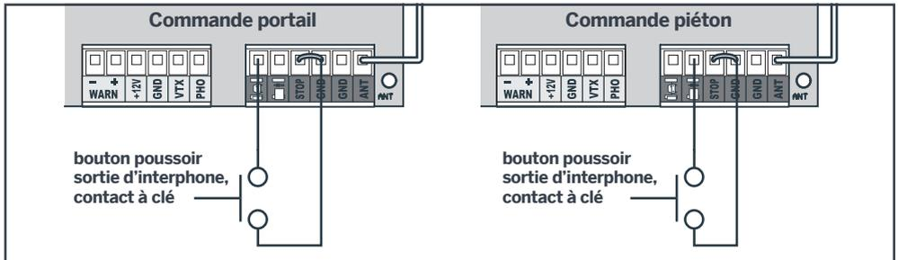
Il est possible d'utiliser plusieurs organes de commande filaires sur la même entrée, pour cela il faut les brancher en parallèle :
