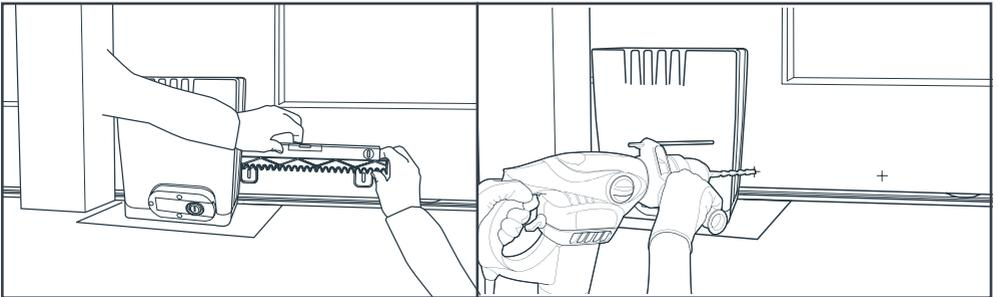
La crémaillère doit être parfaitement à l'horizontal, utilisez un niveau si nécessaire. Laissez une distance de 1 à 2 mm maximum entre la crémaillère et la roue dentée du motoréducteur.
