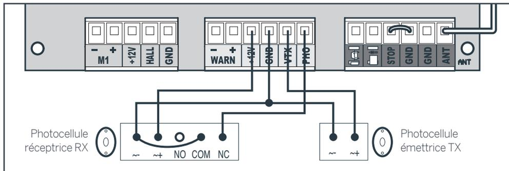
Quand les photocellules sont alimentées, un voyant rouge est allumé à l'intérieur de chacune. Lorsque les photocellules sont alignées, un seul voyant rouge s'allume à l'intérieur de la photocellule RX. Si les photocellules ne sont pas alignées, un deuxième voyant s'allume dans la photocellules RX.
