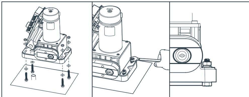
Lorsque le moteur est bien horizontal, serrez les contre-écrous pour bloquer l'écrou de serrage puis serrez les écrous de serrage pour maintenir le moteur en position.
