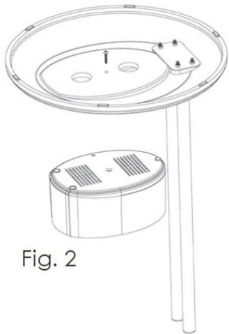
Attachez la base de l'humidificateur à la base du ventilateur en utilisant la vis fournie (Fig.2).
