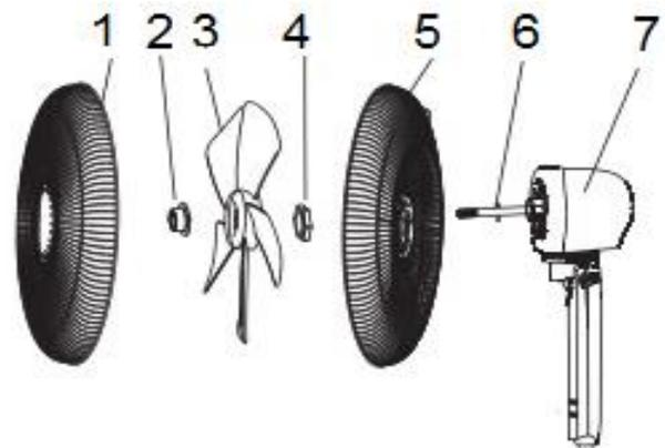
Placez la grille avant sur la grille arrière, attachez les clips (Fig 4) et resserrez la vis de verrouillage (Fig 5).
