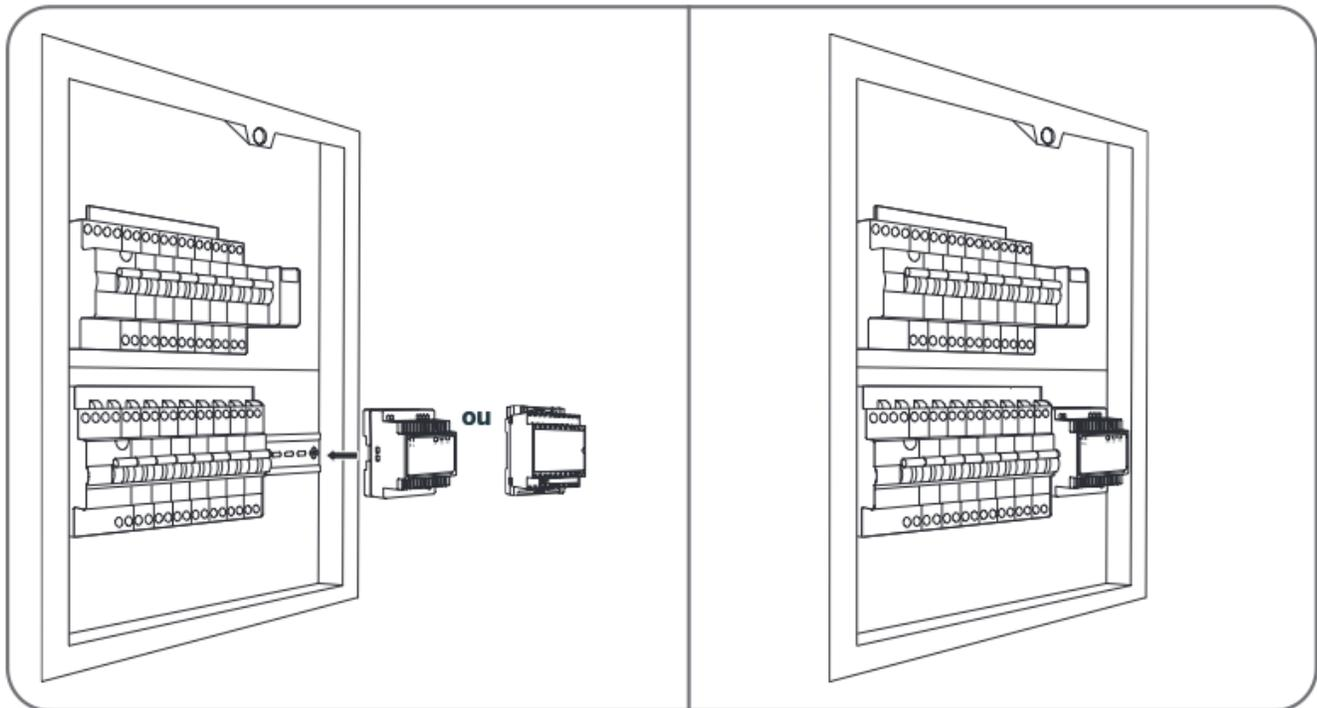
Si vous ne souhaitez pas installer le transformateur dans un coffret existant, fixez le rail fourni à l'aide des vis et chevilles fournies.
