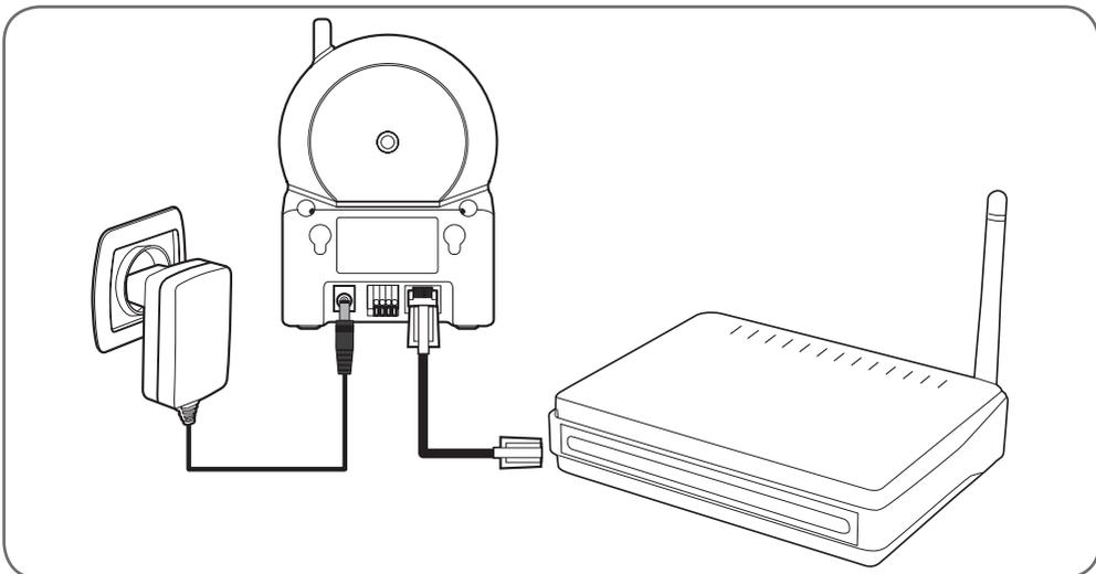
Remarque : une connexion filaire est obligatoire lors de la mise en service, même si on souhaite utiliser une connexion wifi par la suite.
