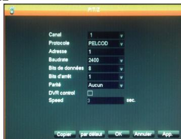
Hiermee kunt u het beheer van bekabelde uitgang voor het draaien van gemotoriseerde PTZ camera's (niet meegeleverd) instellen. Te koppelen aan menu **P/T/Z** hoger en aan de configuratie van de gemotoriseerde camera's (raadpleeg de gebruikershandleiding voor meer details).
