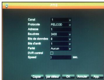
Hier können Sie den Kabelausgang für die Steuerung der motorisierten PTZ-Kameras (nicht im Lieferumfang enthalten) verwalten. Auf das Menü **P/T/Z ("P/T/Z")** weiter oben mit der Konfiguration für motorisierte Kameras abzustimmen (konsultieren Sie die entsprechenden Bedienungsanleitungen für weitere Informationen).
