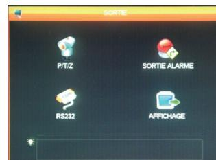
Qui si accede a tutte le funzioni che permettono di gestire e pilotare le telecamere motorizzate, visualizzare allarmi e altre funzioni.
