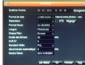
Hier stelt u de datum, het uur, het uurformaat, de weergavetaal, de naam van het netwerk van uw apparaat in.
