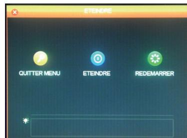
Le permite salir, apagar o reiniciar. La función **«Quitter menu»** (Salir del menú) hace que sea obligatorio indicar un identificador y una contraseña válida para acceder de nuevo al menú general. La función **«Eteindre»** (Apagar) interrumpe las funciones del kit de videovigilancia, desconecta a los usuarios conectados a distancia y después, le invita a pulsar el interruptor de inicio/parada.
