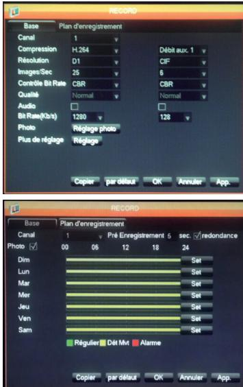
Registerkarte **"Base"** ("Grundeinstellungen"): Hier können Sie für jede Kamera die Größe, die Komprimierung und die Frequenz (Anzahl Bilder pro Sekunde) festlegen sowie bestimmen, ob die Aufzeichnung mit Ton erfolgen soll (sofern eine Audioquelle an die RCA-Eingänge 1 bis 4 angeschlossen ist; für die anderen Kanäle nicht verfügbar).
