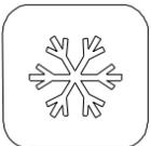
Bouton rafraîchissement: Appuyez pour activer la fonction rafraichissement. la pompe à eau située à l'intérieur de l'appareil commence à fonctionner pour humidifier le filtre structure nid d'abeille et ainsi rafraichir l'air.
